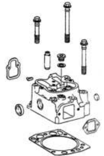
Cilindarska glava posebno za svaki cilindar motora
